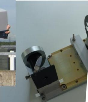
**Das neue kompakte EM27/SUN Spektrometer für Atmosphärenmessungen**
